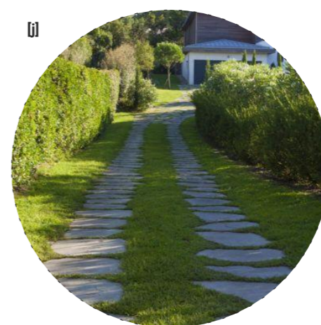
Nahrazení původní silnice pro zásobování kolejnicemi z dlažby nebo zátěžovým trávnikem
